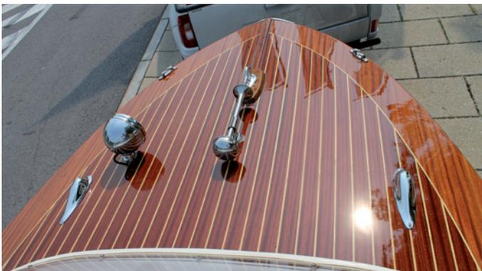
Das Boot wurde 1960 in Kirchberg von der Firma Boesch gefertigt. Im Jahre 2012 komplett restauriert, alle Beschläge und das Holzdeck sind erhalten geblieben. Der Rumpf wurde in lichtem grau lackiert. Das Boot wurde für einen Elektroantrieb vorbereitet.
